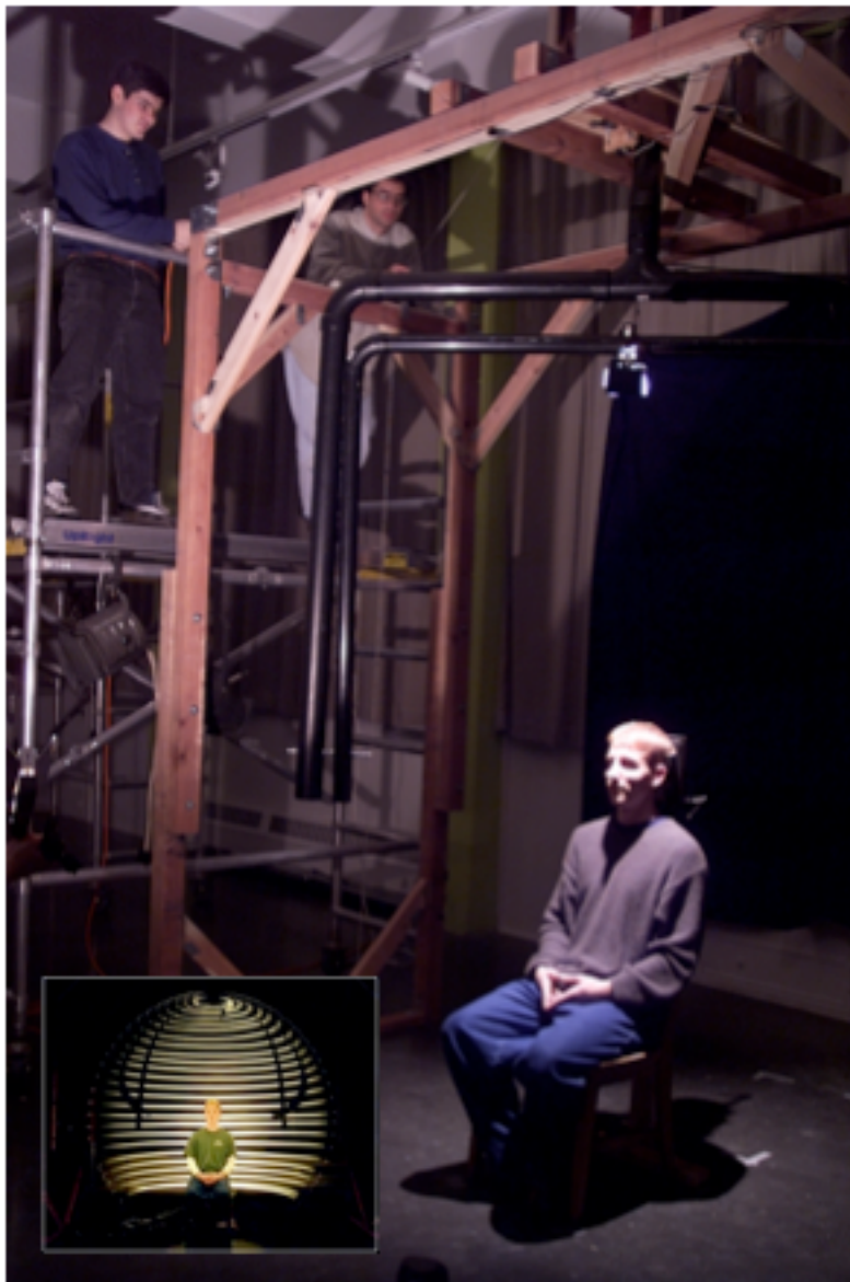
Kuva 2: Kuvassa on valolava, jota käytetään BRDF:n muodostamiseen tarvittavien mittausten suorittamiseen. Pikkukuvassa pitkällä laukaisujalla saatu kuva valolavan toiminnasta
